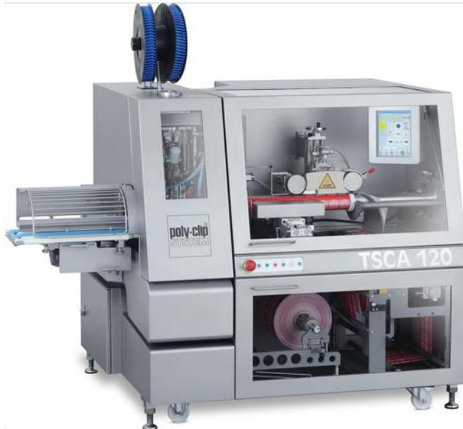
**Poly-clip System TSCA 120** – die Siegel-Clip-Maschine produziert innovative Verpackung mit Easy-opening Aufreißhilfe für Wurst-Snacks und Kleinportionen.
