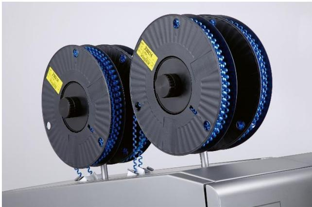
**Poly-clip System FCA 160 XL** – höchste Haltkraft durch 4-Clip-Betrieb.
